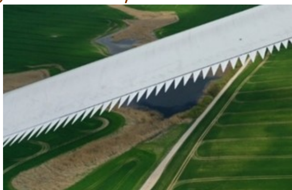
Figure 17 : Système de peigne installé sur une pale d'éolienne
